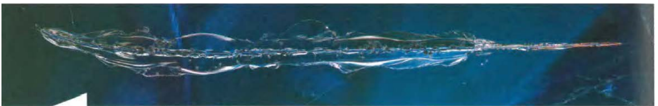
Bild 1: Durch Begehung induzierter Kratzer auf ESG [Quelle: Schula TU Darmstadt]
